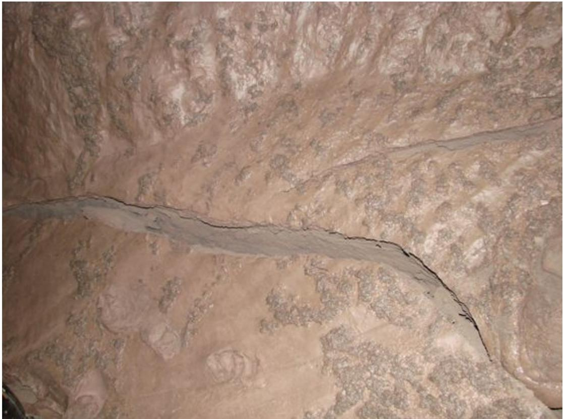
图 4.3-7 细泥脱水后开裂
